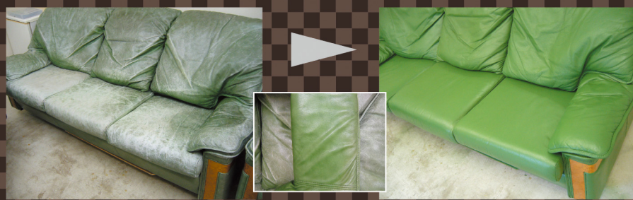
●修理前。購入時の色が全く想像できないほど色あせ、ひび割れのある革のソファ。(※写真はクッション材の補修済み) ●裏面や隙間から色あせ前の色を探し出し、同じ色に調合した塗料を作ります。(中央部が色あせ前の色!) ●表面にペーパーをかけ、ひび割れ修理後カラーリング。手触り感を整えて完了。見事によみがえりました。
